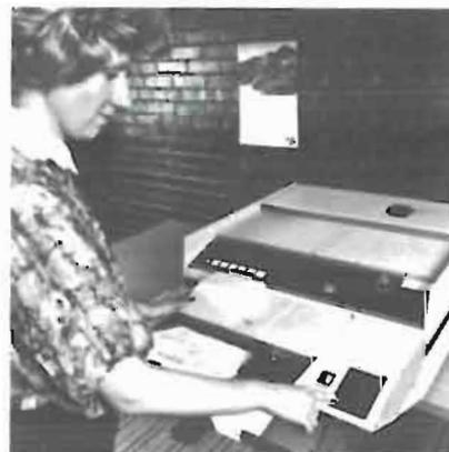
L'Enlarger Printer 624 della 3M permette la riproduzione di disegni tecnici microfilmati su aperture cards.
