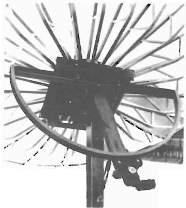
Fig. 6 - Specchio a forma di paraboloide del diametro di tre metri; costituito da tanti «spicchi» fissati ad una leggera ma robustissima struttura di profilati di lega d'alluminio. Peso antenna montata kg. 50; superficie = 7m<sup>2</sup>; distanza focale = 0,47 diametro = 141 cm. Resiste a venti di 160 km/h
